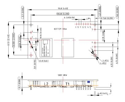
UNIT: mm[inch] PIN: L=3.8±0.25mm TOLERANCE: X.Xmm±0.5mm[X.XX in.±0.02in.] X.XXmm±0.25mm[X.XXX in.±0.01in.]
