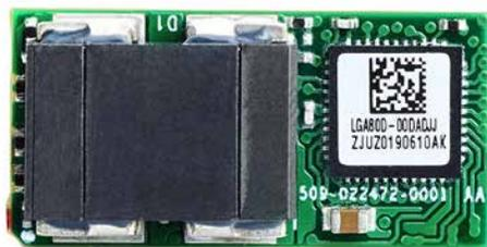
各モジュールは個別に調整可能な40 A、100 W の2出力を備え、単出力に組合せて調整可能な80 A、200 W もできます。最大4ユニットを並行接続したさらに単出力電源として最大320 Aが供給可能です。
