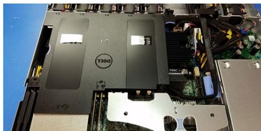
Chassis fan baffle
